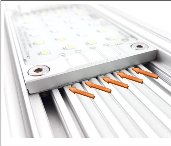
2. Moderates und gleichmäßiges Festziehen der Schrauben bis der Spalt zwischen Modulunterseite und den Profilstegen geschlossen ist und das Wärmeleitpad, wie auf dem Bild zusehen, etwas herausdrückt.
