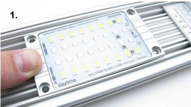
**Modulfixierung durch manuelles Einpressen in 2 Schritten:**
