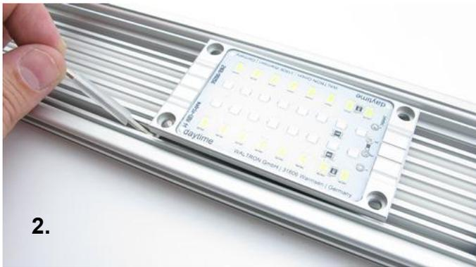
**⚠️Achtung! Die Gummierung des kurzen Schlüsselschenkels muss vorhanden sein und die Schlüsselkanten vollständig bedecken, um die Modulunterseite nicht zu beschädigen.**
