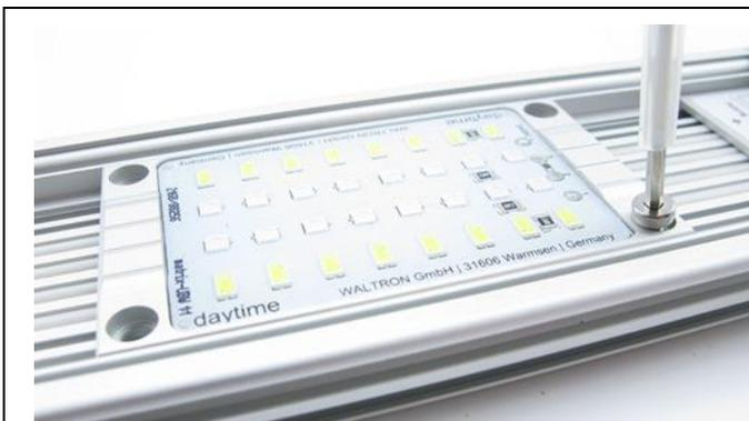
Lösen und Entnehmen aller Schrauben
