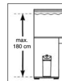
Respectați distanța de 180 cm max. între suprafața apei și fundul filtrului pentru a obține o siguranță optimă de funcționare.
