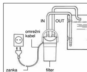
Zaradi vaše lastne varnosti vam priporočimo, da z omrežnim kablom napravite odkapljalno pentijo, ki bo preprečevala, da bi vzdolž kabla tekla voda v vtičnico.
