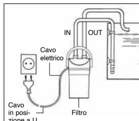
Per Vosstra personale sicurezza consigliamo di verificare che il cavo elettrico rimanga in posizione a U per evitare che eventuali fuoriuscite di acqua, scivolando lungo il cavo, raggiungano la presa. Qualora per esempio si usi una presa multipla ausiliaria, verificare che sia posizionata più in alto rispetto all'allacciamento a rete del filtro esterno.
