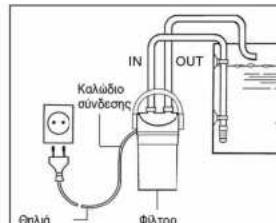
Για την σωματική σας ασφάλεια συνιστούμε να σηματίσετε το καλώδιο σύνδεσης μια θηλιά σταλάγματος (κοιλιά) για να σταλάζουν εκεί τα τυχόν νερά που τρέχουν κατά μήκος των ρευματοδότη (πρίζας). Για παράδειγμα, χρησιμοποιήστε ένα πολλαπλό ρευματοδότη που να τοποθετείται σε ψυλότερη σημείωση από την σύνδεση ρευματοδότη του εξωτερικού φίλτρου.
