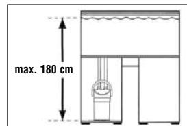
Ten behoeve van een optimale bedrijfszekerheid mag de hoogte tussen wateroppervlak en filterbodem maximaal 180 cm bedragen.
