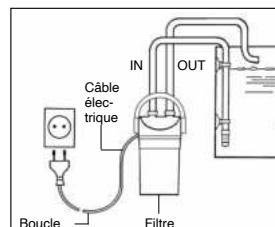
Pour votre propre sécurité, nous vous recommandons de conférer au cordon la forme d'une boucle d'égouttement. Ceci empêchera que de l'eau ne s'écoule se long du cordon et n'atteigne la prise femelle. Si vous utilisez une prise multiple, il faudra la placer au-dessus du moyen de raccordement du filtre.
