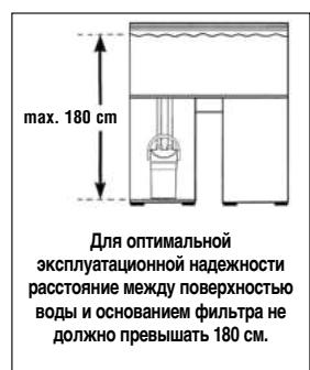
Для оптимальной эксплуатационной надежности расстояние между поверхностью воды и основанием фильтра не должно превышать 180 см.
