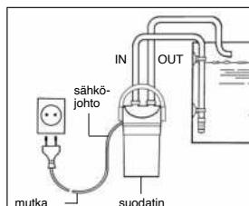
Oman turvallisuutesi vuoksi varmista että suodattimen sähköjohtoa ei vedetä suoraan pistorasiaan vaan asetetaan piiroskuvan mukaisesti mutkalle. Tämä estää vesipisaroiden pääsyn pistorasiaan.
