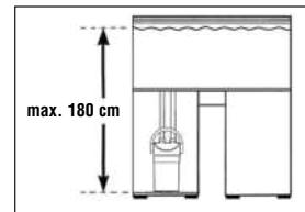
Acordați atenție distanței pe înălțime prevăzută. Ar trebui să existe maximum 180 cm între suprafața apei și fundul filtrului pentru a obține o funcționare optimă.
