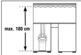
Спазвайте изисканото разстояние за височина. Между водната повърхност и дъното на филтера трябва да има не повече от 180 см, за да се постигне оптимален начин на работа.
