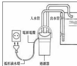
為了您個人的安全，建議您用電源電纜製成一個弧形滴水環，這樣能防止流水沿著電纜進入電纜插座中。使用接插板時，注意它的定位應高於過濾器的電源介面。
