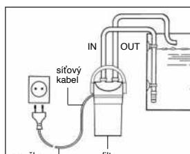
Pro Vaši vlastní bezpečnost doporučujeme na kabelu síťového zapojení vytvořit smyčku, abyste zamezili průniku vody podél kabelu do elektrické zásuvky.
