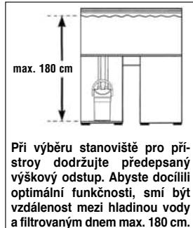
Při výběru stanoviště pro přístroj dodržujte předepsaný výškový odstup. Abyste docílili optimální funkčnosti, smí být vzdálenost mezi hladinou vody a filtrovaným dnem max. 180 cm.
