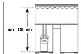
Pour obtenir une sécurité de fonctionnement optimale, la distance entre la surface de l'eau et le fond du filtre ne doit pas dépasser 180 cm.
