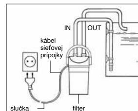
Pre Vašu bezpečnosť doporučujeme, urobiť na prívodnom káble slúčku na odkvapkovanie, ktorá zamedzí, aby sa eventuálne po káble stekajúca voda nedostala do sieťovej zástrčky.
