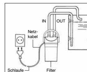
Zu Ihrer eigenen Sicherheit empfiehlt es sich, mit dem Netzkabel eine Tropfschlaufe zu bilden, die verhindert, dass evtl. am Kabel entlang laufendes Wasser in die Steckdose gelangt. Bei Verwendung einer Verteiler-Steckdose muss die Platzierung oberhalb des Filter-Netzanschlusses erfolgen.
