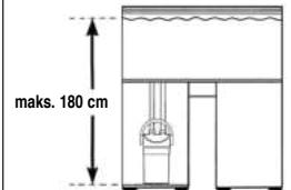
Öngörülen yükseklik mesafesine dikkat edin. Optimum çalışmaya sağlamak için su yüzeyi ilefiltre tabanı arasındaki mesafe maksimum 180 cm olmalıdır.
