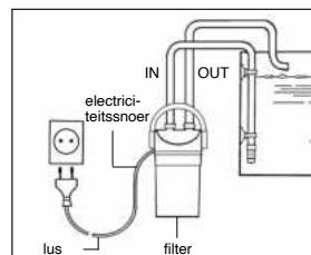
Voor Uw eigen veiligheid is het aan te bevelen met het snoer een druppellus te creëren, die verhindert, dat eventueel langs de kabel lopend water in het stopcontact komt.
