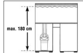
Pri výbere stanoviska pre prístroj dodržujte predpísaný výškový odstup. Aby ste docieliili optimálnu funkčnosť, smie byť vzdialenosť medzi hladinou vody a filterovaným dnom max. 180 cm.
