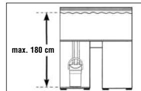
Para obtener una óptima seguridad de funcionamiento, la máxima distancia entre la superficie del agua y el fondo del filtro no deberá ser superior a 180 cm.
