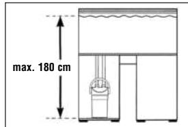
Al fine di ottenere una sicurezza ottimale di funzionamento devono esserci tra la superficie dell'acqua e la base del filtro al mass. 180 cm.
