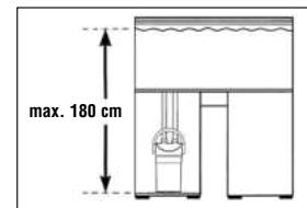
Achten Sie auf den vorgeschriebenen Höhenabstand. Zwischen Wasseroberfläche und Filterboden dürfen max. 180 cm liegen, um eine optimale Arbeitsweise zu erzielen.
