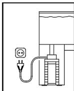
Pre vašu vlastnú bezpečnosť odporúčame vytvoriť s pripájacím káblom odkvapkávaciu slučku, ktorá zabráni prípadnému stekaniu vody pozdĺž kábla do sieťovej zásuvky.
