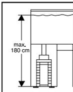
在选择设备安放地时，请注意安置高度。为了达到最佳的安全性能，应该允许水面与过滤器安放平面之间有最大 180 cm 的距离。
