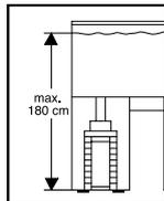
Ved valg av plassering av apparatet, må man passe på plasseringshøyden. For å oppnå optimal funksjonssikkerhet, skal det være maks. 180 cm mellom vannoverflaten og bunnen av filteret.
