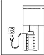
Para su propia seguridad se recomienda el formar un lazo de goteo con el cable de conexión para evitar que el agua que fluya a lo largo del cable pueda llegar a la toma de corriente.
