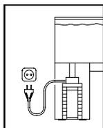
Pro vaši vlastní bezpečnost doporučujeme vytvořit s připojovacím kabelem odkapávací smyčku, která zabrání případnému stékání vody podíl kabelu do síťové zásuvky.
