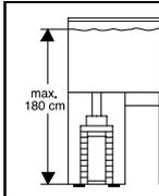
Tenga en cuenta la altura de instalación al escoger el lugar de ubicación del aparato. Para conseguir una seguridad óptima en el funcionamiento, puede haber un máximo de 180 cm entre la superficie del agua y el suelo del filtro.
