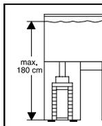
Pri výbere miesta inštalácie prístroja dbajte na výšku inštalácie. Aby bola dosiahnutá optimálna prevádzková bezpečnosť funkcií, medzi hladinou vody a dnom filtra smie byť najviac 180 cm.
