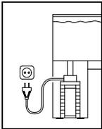
Zu Ihrer eigenen Sicherheit empfiehlt es sich, mit dem Anschlusskabel eine Tropfschlaufe zu bilden, die verhindert, dass evtl. am Kabel entlang laufendes Wasser in die Steckdose gelangt.
