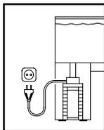
Per la vostra sicurezza, è consigliabile formare un nodo di sgocciolamento con il cavo di collegamento, per evitare che l'acqua che scorre lungo il cavo possa penetrare all'interno della presa di corrente.
