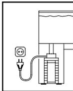
Oman turvallisuutesi vuoksi suosittelemme, että jätät sähköjohtoon tippamutkan, jotta akvaariosta mahdollisesti johtoa pitkin valuva vesi ei pääse pistorasiaan.
