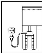
Med henblik på egen sikkerhed anbefales det at lave en dråbeløkke på tilslutningskablet for at forhindre, at vand, der løber hen ad slangen, når stikdåsen.
