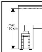
Ao escolher um local para o aparelho, deve-se ter em atenção a altura de montagem. Para obter uma segurança funcional perfeita, a distância entre a superfície da água e a base do filtro tem de ser de 180 cm no máximo.
