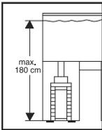
기기의 작동 부지를 선택할 때는 설치 높이를 고려합니다. 최적의 기능 안전을 보장하기 위해 물 표면과 필터 바닥 사이의 간격을 최대 180 cm로 하십시오. 목재 처리에 다수의 래커와 폴리쉬가 사용되므로 기기 발은 가구 또는 교각 바닥에 가시적인 잔류물을 남길 수 있습니다. 따라서, 장치 아래에 패드가 없는 목재 표면에 기기를 배치하지 마십시오. 필터는 항상 직립한 상태에서에서만 작동해야 합니다.
