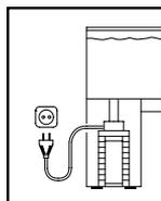
Nous recommandons, pour votre sécurité, de former une boucle d'égouttement avec le câble de raccordement, permettant d'éviter que de l'eau s'écoulant le long du câble ne pénètre dans la prise.
