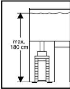
Let bij de plaatsing van het apparaat op de opstelhoogte. Voor een optimale werking mag tussen wateroppervlak en filterbodem maximaal 180 cm liggen.
