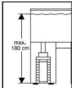
При выборе места установки устройства следует обратить внимание на высоту установки. Чтобы получить оптимальную функциональную безопасность, между поверхностью воды и дном фильтра должно быть не более 180 см.
