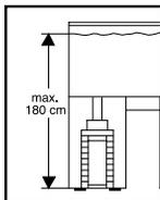
Vær opmærksom på optillingshøjden, når enheden sættes op. For at opnå optimal funktionssikkerhed må der maks. være 180 cm mellem vandoverflade og filterbund.
