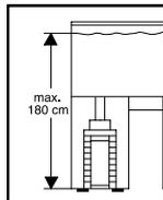
La alegerea locației de amplasare a aparatului se va avea în vedere înălțimea de instalare. În vederea siguranței optime în funcționare, distanța dintre suprafața apei și baza filtrului va fi de max. 180 cm.
