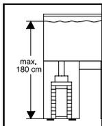
Podczas wybierania miejsca ustawienia urządzenia zwróć uwagę na wysokość ustawienia. Aby uzyskać optymalną wydajność działania, między lustrem wody a dnem filtra może być różnica wysokości maks. 180 cm.
