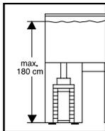
Per la scelta della sede dell'apparecchio, occorre tenere in considerazione l'altezza di installazione. Al fine di ottenere una sicurezza di funzionamento ottimale, è necessario calcolare una distanza massima di 180 cm tra la superficie dell'acqua e il fondo del filtro.
