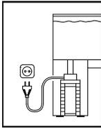
圈，这样可以防止水沿着导线流入插座。
