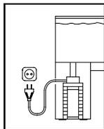
For din egen sikkerhet anbefales det å lage en dråpesøyfe på tilkoblingskabelen, som forhindrer at det renner vann langs kabelen til stikkkontakten.
