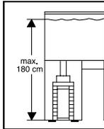
Όταν επιλέγετε το σημείο τοποθέτησης της συσκευής λάβετε υπ' όψιν σας το ύψος τοποθέτησης. Για να μεγιστοποιηθεί η ασφάλεια λειτουργίας, η απόσταση μεταξύ της επιφάνειας του νερού και της βάσης του φίλτρου δεν πρέπει να ξεπερνάει τα 180 cm.
