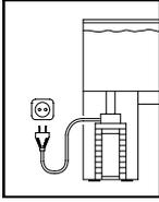
Voor uw eigen veiligheid is het aan te raden met de aansluitkabel een druiplus te vormen die voorkomt dat water langs de kabel loopt en in het stopcontact terecht komt.
