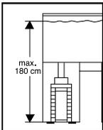
Bei der Wahl des Gerätestandortes auf die Aufstellhöhe achten. Um eine optimale Funktionssicherheit zu erzielen, dürfen zwischen Wasseroberfläche und Filterboden max. 180 cm liegen. Da bei der Holzverarbeitung eine Vielfalt von Lacken und Polituren verwendet werden, können die Gerätefüße sichtbare Rückstände auf Möbeln oder Parkettböden hinterlassen.
