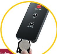
3. Setzen Sie die Batteriehalterung wieder ein und schließen Sie das Batteriefach.
