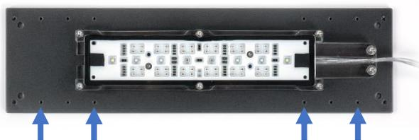
Gewindelöcher im Chassis zur Befestigung der Halterungen.
